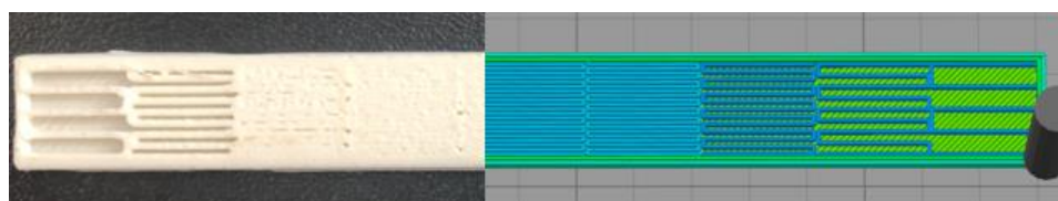
Figura 5.4 Epruvetă îmbunătățită în timpul procesului de imprimare fără a genera pereți subțiri între diferite setări. (Partea stângă: specimenul imprimat, partea dreaptă: setările imprimantei)
