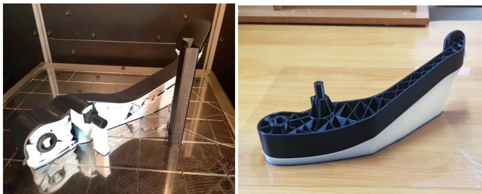
Figura 5.10 Modele imprimate ale pedalei de frână. a) cu filamentele orientate transversal în raport cu axa longitudinală a pedalei, b) model cu filamentele orientate după axa longitudinală a pedalei
