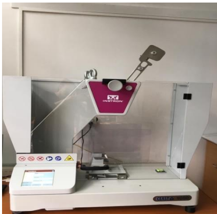
Figura 4.4 Standul experimental pentru încercarea de încovoiere prin șoc: a) ciocanul Charpy, b) fixarea epruvetei cu creștătură
