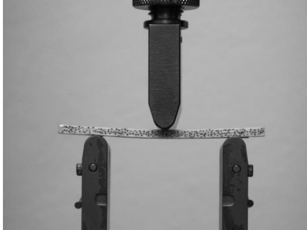
Figura 5.1 Încercarea la încovoiere în trei puncte pentru proba imprimată 3D cu rată de umplere variabilă.
