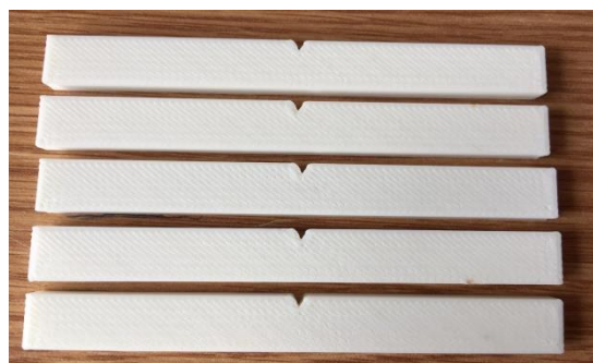
Figura 4.2 Epruvete imprimate 3D având creștătură în V cu diferite rate de umplere
