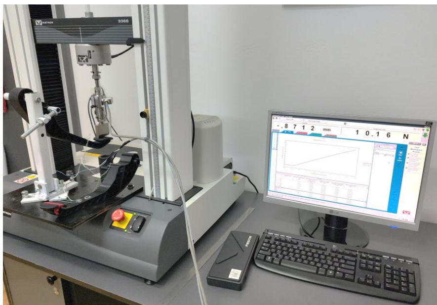
Figura 5.11 Standul experimental pentru studiul comportamentului mecanic al pedalei de frână imprimată 3D
